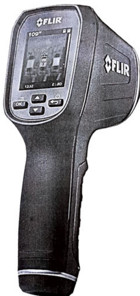
Picture 4 FLIR TG 167 Thermal imager
